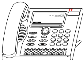
Base di supporto, utilizzabile anche come telaio di montaggio per l'installazione a parete
